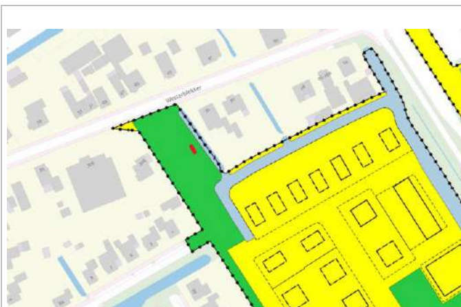
Afbeelding 1: Uitsnede ontwerp met locatie van het gasdrukmeet- en regelstation (rode punt).
