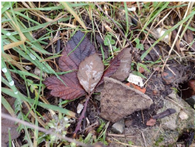
Foto 4: 2934 Asbest op maaiveld 800
