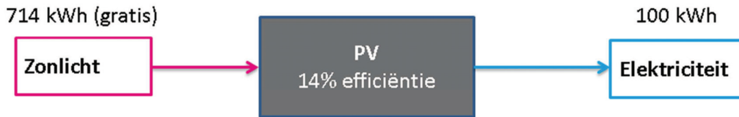
Figuur 9: Elektriciteitsopwekking met PV. De opmerking (gratis) slaat op het feit dat het volledig hernieuwbare energie is.
