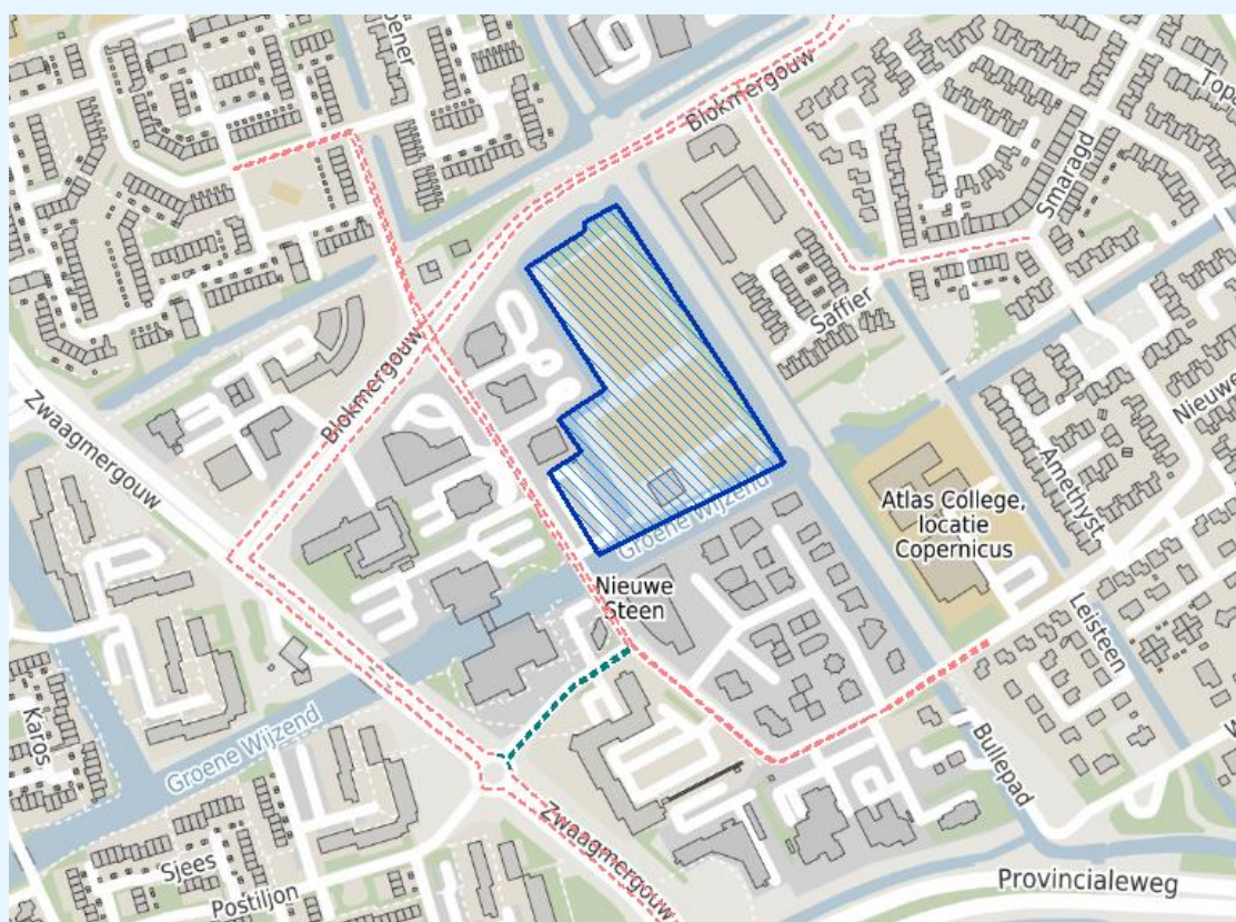
figuur 4: ligging wegvakken van de akoestisch relevante wegen (rood). De overgang van de Nieuwe Steen naar de Zwaagmergouw heeft een afwijkend wegdektype (groen).
