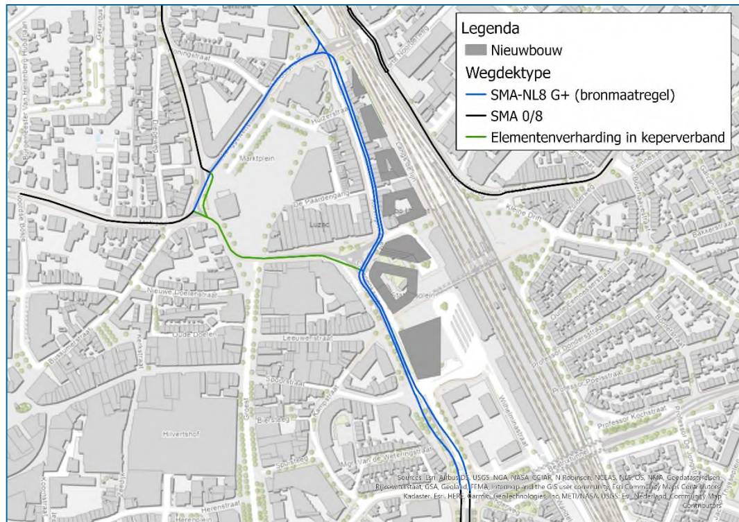
Afbeelding 6.1 Wegvakken waarvan wordt geadviseerd te voorzien van een geluidreducerende wegdekverharding van het type SMA-NL8 G+.
