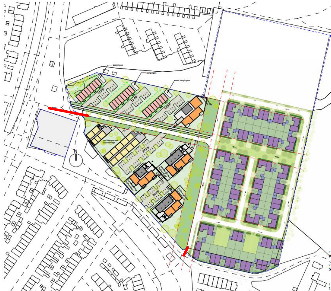
Figuur 2: Aansluitingsmogelijkheid voor het vuilwater aan het bestaande systeem.
