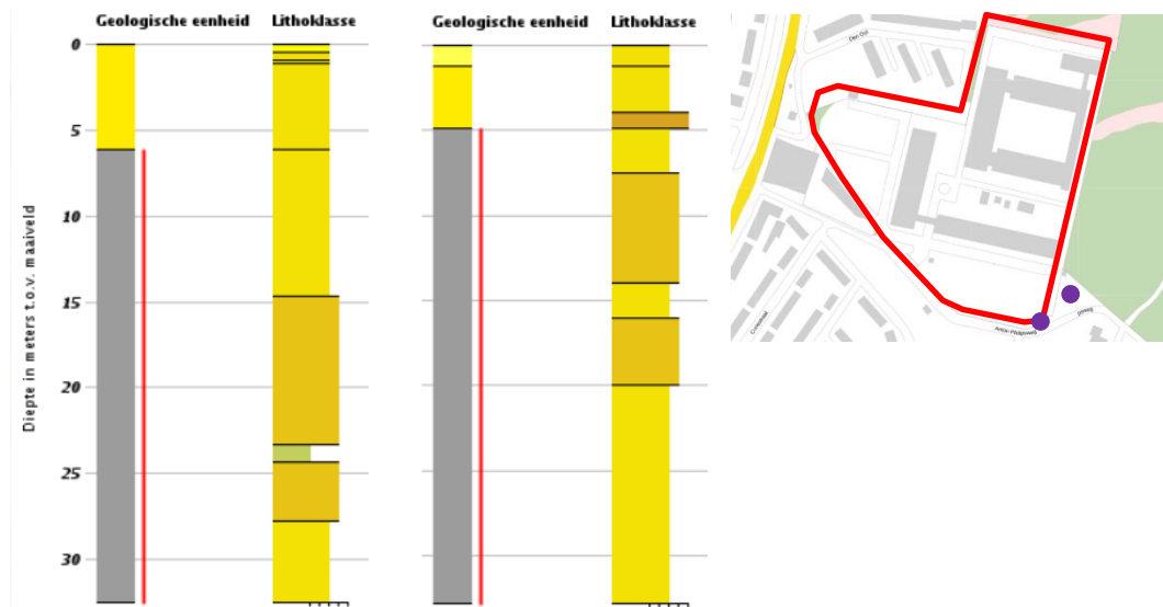
Figuur 5: Twee boringen (B32A0060 en B32A0675, paars) vlak ten zuiden van het plangebied tot een diepte van 33 m –mv (bron: GeoTOP v1.3, DINoloket).
