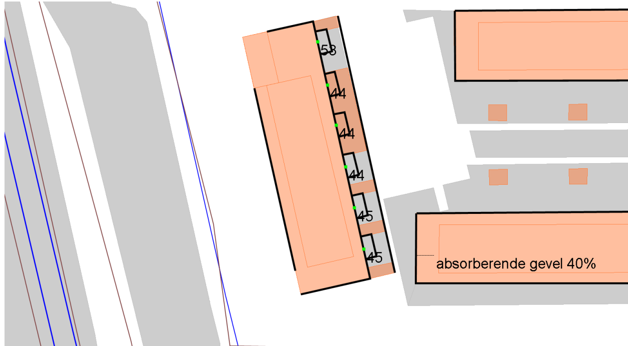
Figuur B1.3: Geluidbelasting tweede verdieping.
