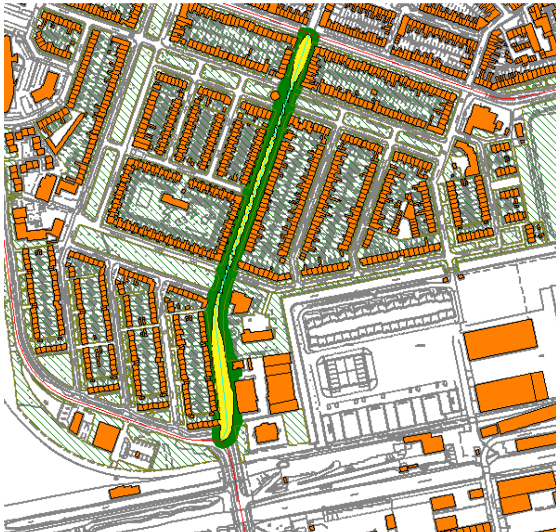
Afbeelding 6.1.1 Geluidcontour Fazantenstraat in 2025, incl. aftrek art. 110g Wgh
