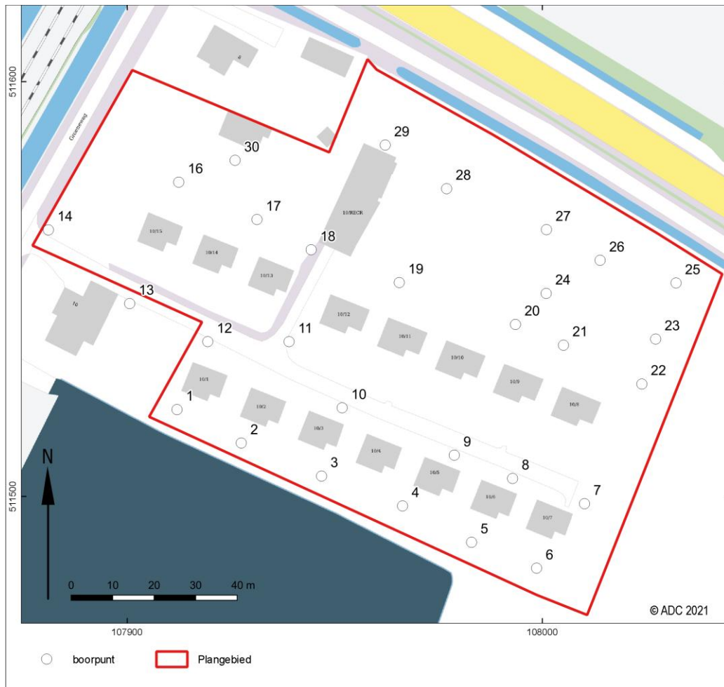
Afb. 3 Plangebied met de uitgevoerde boringen
