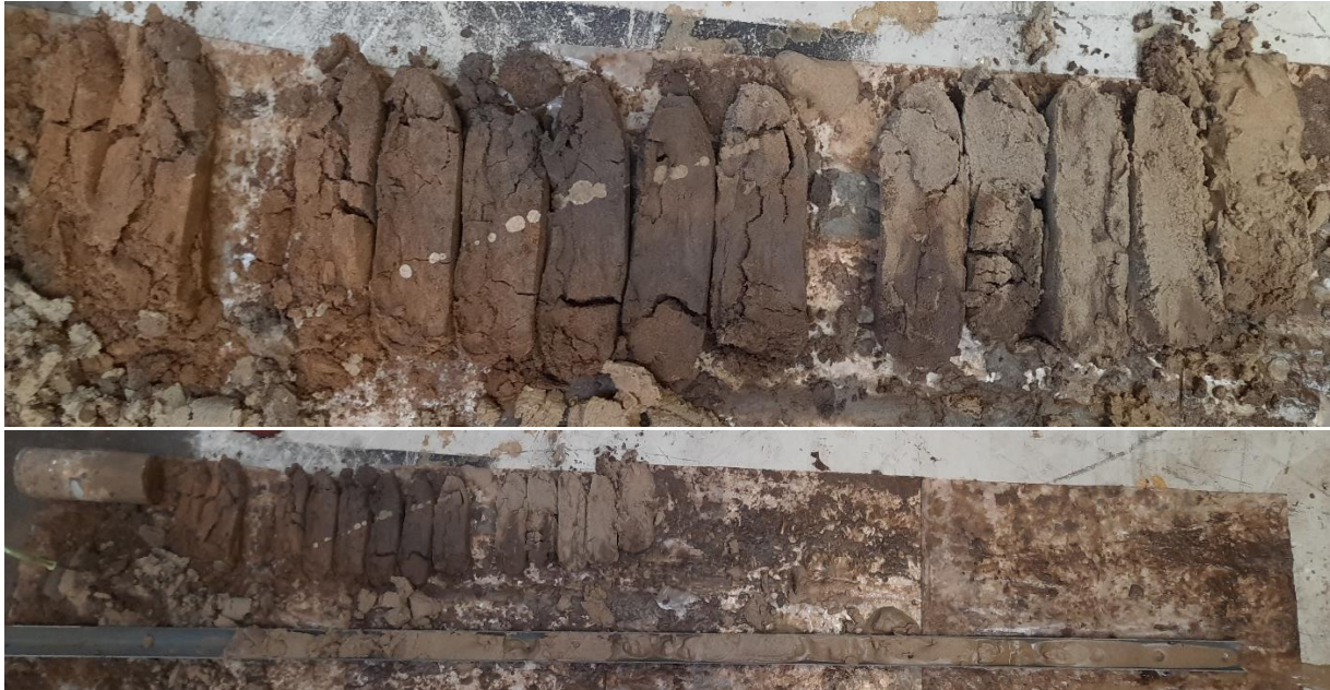
Boring 2 (boven: 30-150 cm -Mv; onder: 0 – 300 cm -Mv). Het archeologisch relevante niveau is herkenbaar als grijsbruine, grauwe (vuile) laag in het midden van de bovenste foto. Het niveau ligt direct boven het grijze strand(vlakte)zand dat in de bovenste foto als grijs zand, rechts van het vegetatieniveau, zichtbaar is.
