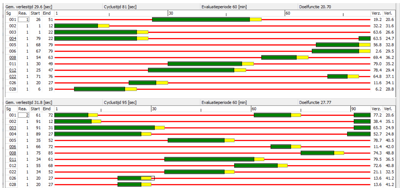
Figuur 4: Resultaat COCON berekeningen N203 – Lagelaan voor de ochtend- en avondspits op basis van het nieuwe kruispuntontwerp
