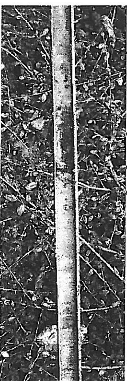
Figuur 3: Foto van boring 7 met daarin het rommelige geelgrijze zandpakket met brokken humeus zand zoals dit in alle boringen onder de toplaag is aangetroffen.
