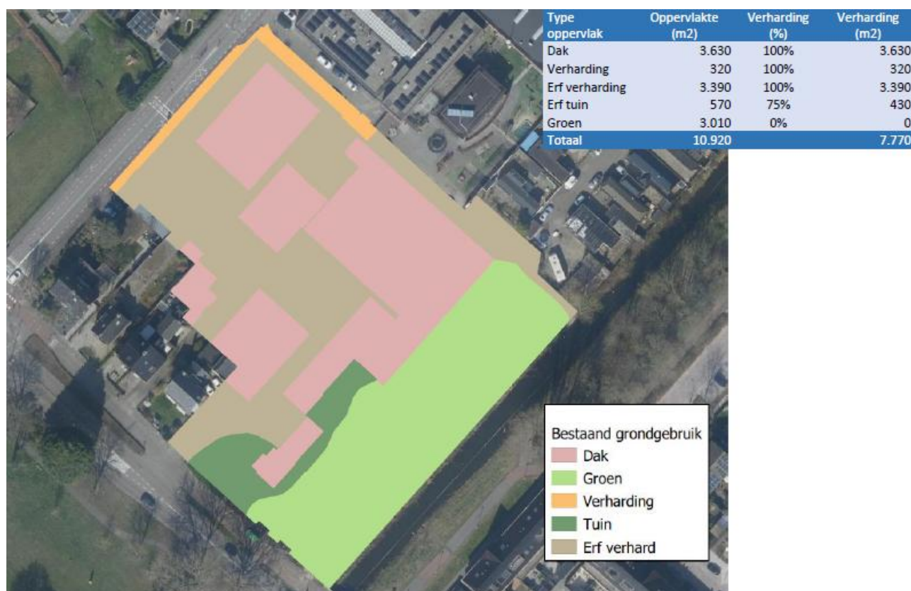
Figuur 5.9 Verharding in voorheen bestaande situatie (bron: initiatiefnemer)
