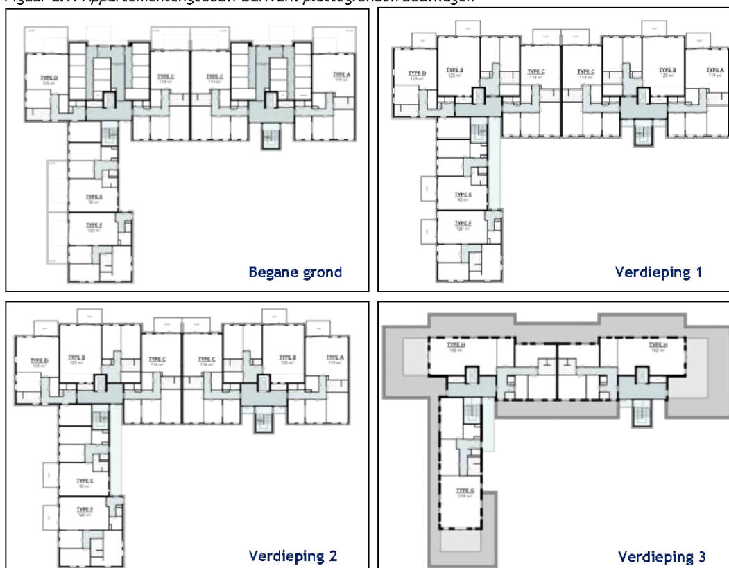
Figuur 2.9: Appartementengebouw DENVER: plattegronden bouwlozen
