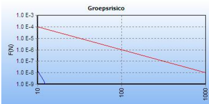
Figuur 5.2 FN curve voor W-532-05 van N.V. Nederlandse Gasunie voor de kilometer tussen stationing 0.00 en stationing 560.00
