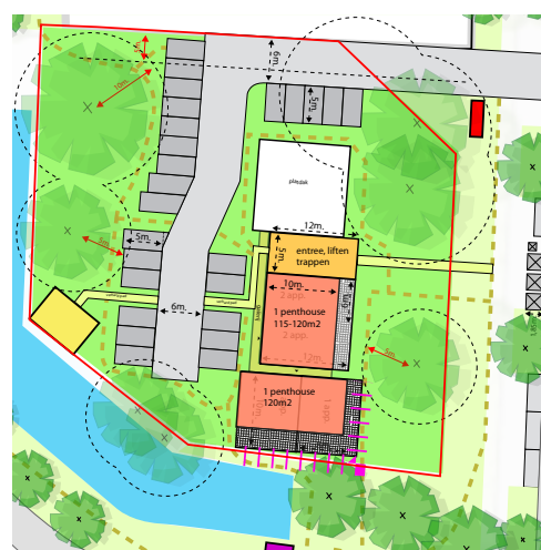
Voorbeelduitwerking: 4de (terugliggende) bouwlaag met twee penthouses
