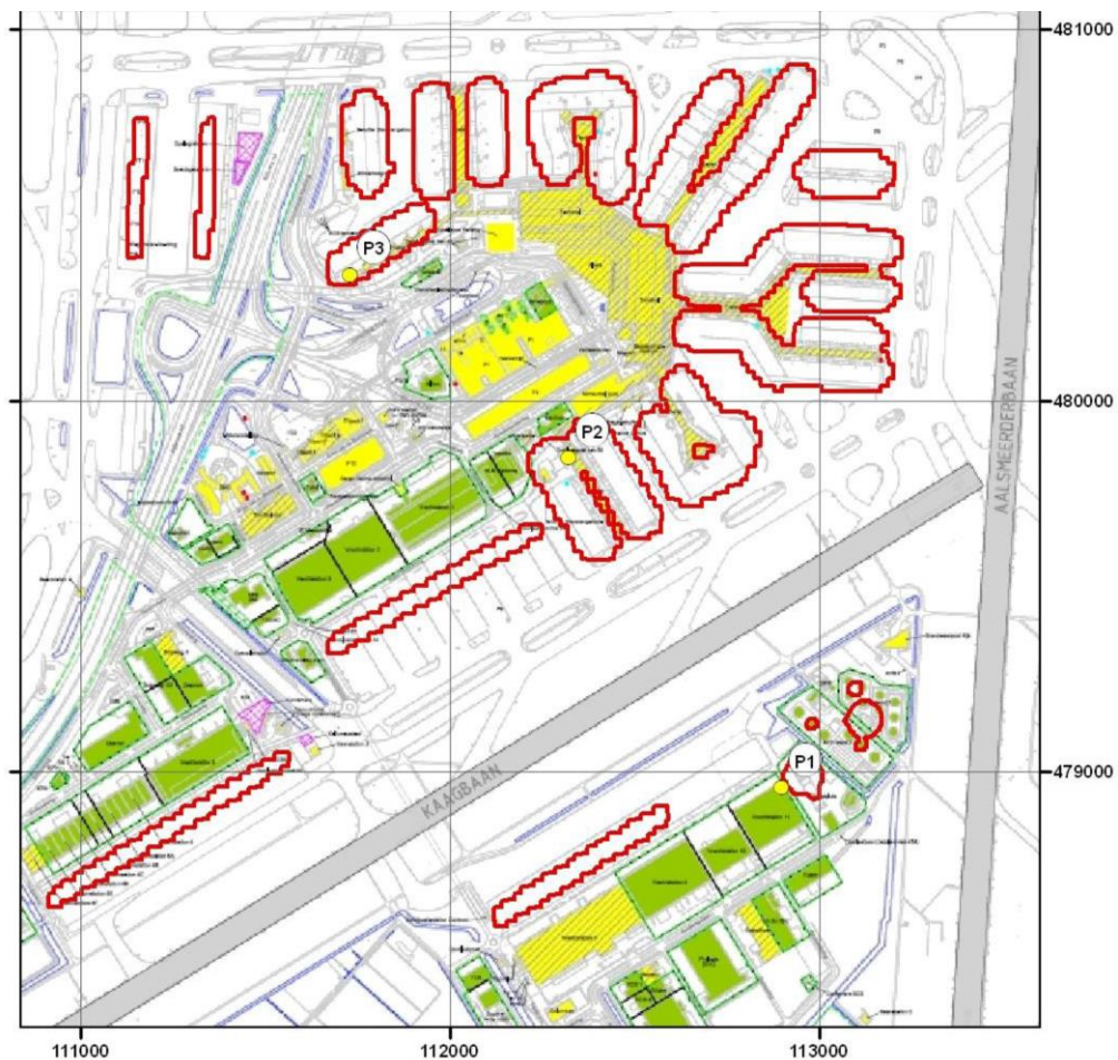
Figuur 2. Plaatsgebonden risicocontouren AFS bij de pieren, vergund (bron: Risicoanalyse Aircraft Fuel Supply, AVIV, 2012)
