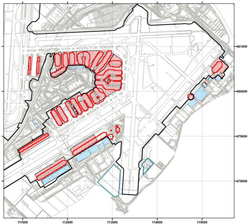
Figuur 3. De rood gearceerde risicocontouren (risicozones in het bestemmingsplan) zullen worden vervangen door de zwarte omhullende veiligheidscontour AFS-Schiphol. In het bestemmingsplan heet dit de veiligheidszone AFS-Schiphol.
