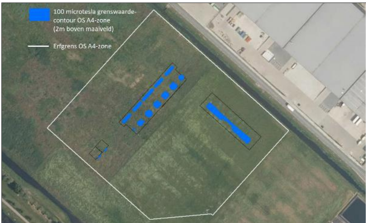
Figuur 5.9: 100 microtesla magneetveldcontour eindsituatie OS A4-zone (2 meter boven maaiveld) (bron: Onderzoek 150/20 kV Onderstation A4-zone 100 microtesla magneetveldcontour, Qirion)
