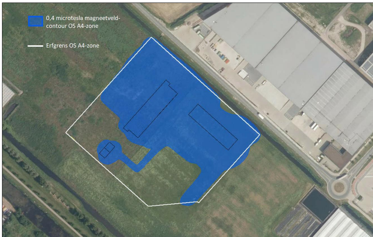
Figuur 5.10: Jaargemiddelde 0,4 microtesla magneetveldcontour van onderstation A4-zone in de eindsituatie. (bron: Onderzoek 150/20 kV Onderstation A4-zone Jaargemiddelde 0,4 microtesla magneetveldcontour, Qirion)
