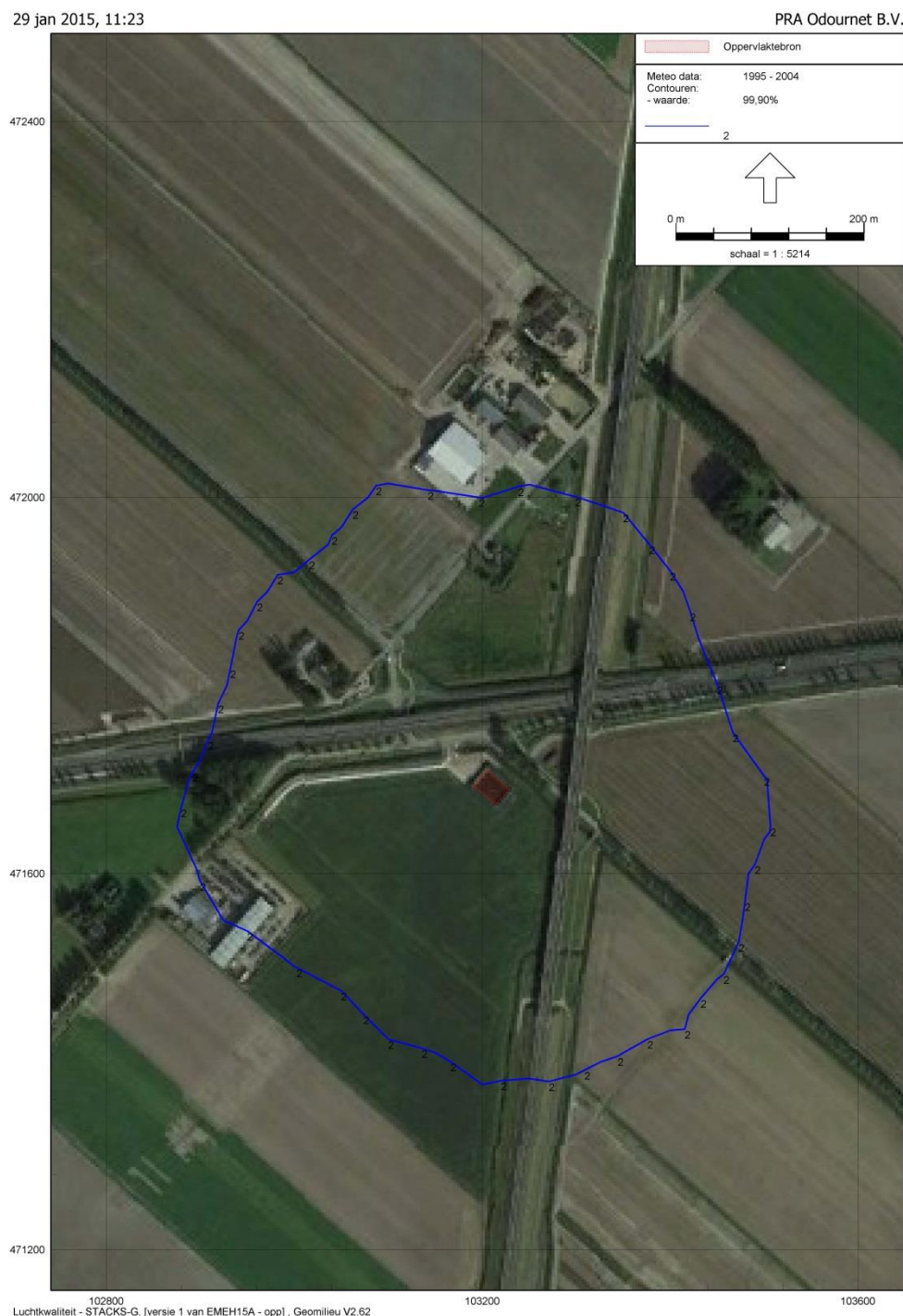
Figuur c Geurcontour van 2,0 \text{ ou}_E(\text{H})/\text{m}^3 als 99,9-percentielwaarde als gevolg van het mestbassin te Abbenes.
