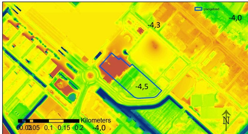
figuur 2-2 Maaiveldhoogten ten opzichte van NAP (bron: AHN3, AHN.nl)
