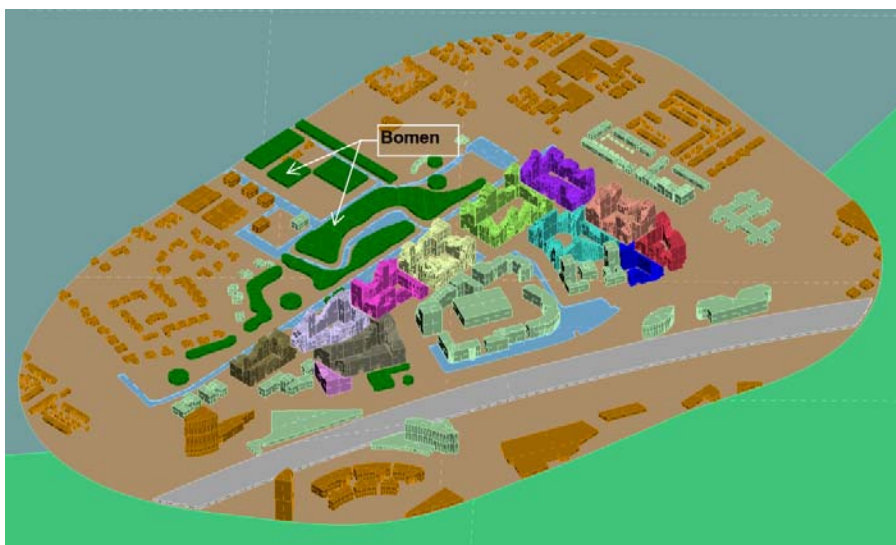
Figuur 4.1: Het aangeleverde 3D model ten behoeve van CFD onderzoek
