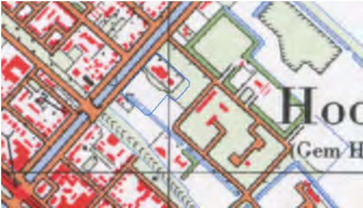
Situatie 1975. Bron: www.topotijdreis.nl . Vanuit de vaart is een zijtak gegraven. Uit de website van het Hoogheemraadschap van Rijnland blijkt dat de zijtak enkele jaren geleden nog is uitgebaggerd met een leggerdiepte van 0,75 m.
