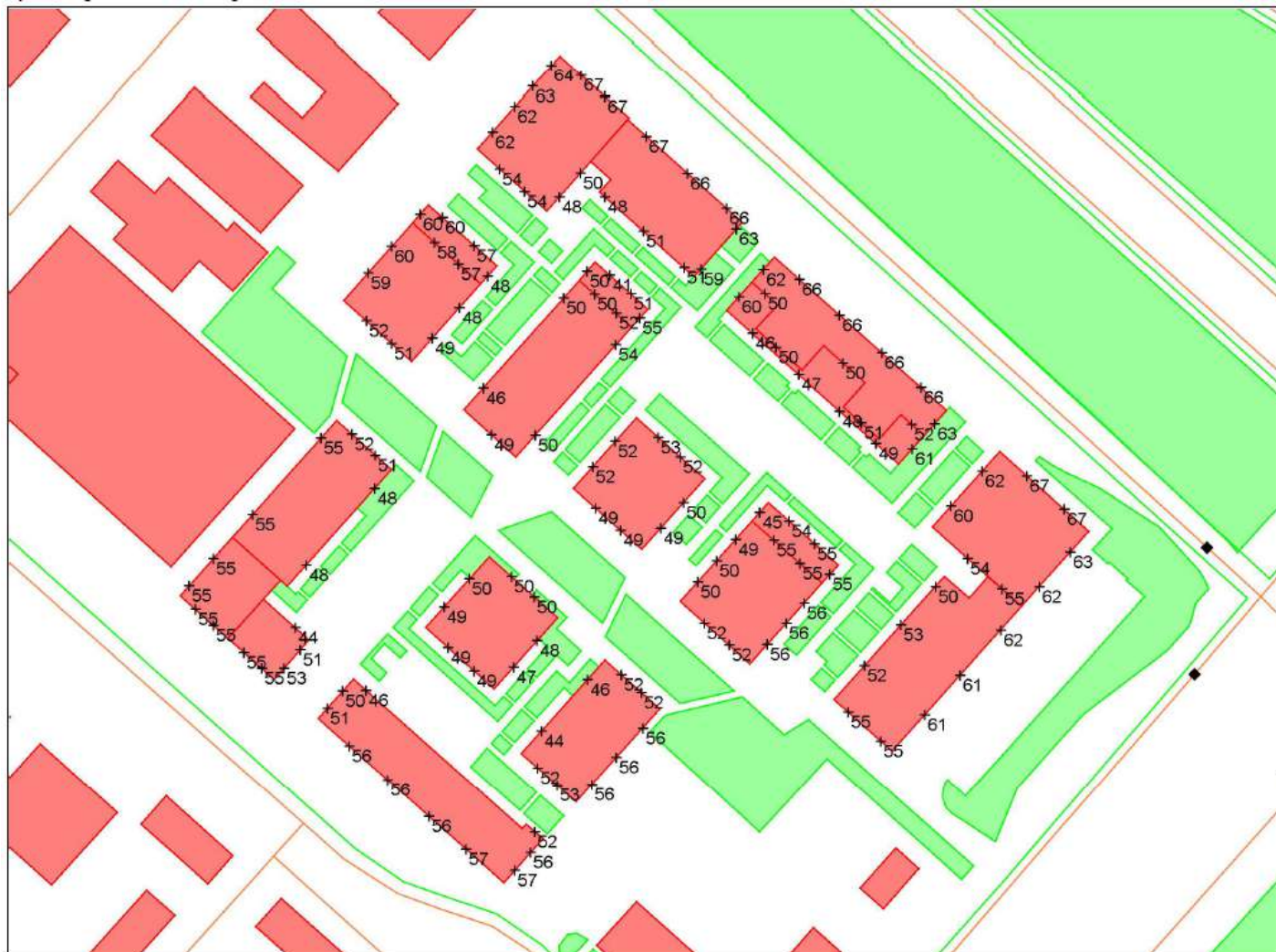
Figuur 2.6 Gecumuleerde geluidbelasting, alle wegen samen exclusief aftrek artikel 110g Wgh, maatgevende hoogte/toetspunt, situatie 2030
