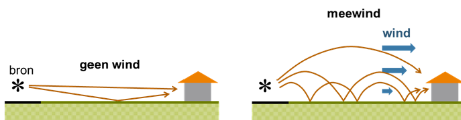
Figuur 2: Geluidoverdracht in een windstille situatie via twee paden (links) en in een situatie met wind van bron naar waarneempunt (meewind) via een groot aantal paden, als gevolg van afbuiging van de geluidvoortplanting richting de bodem.
