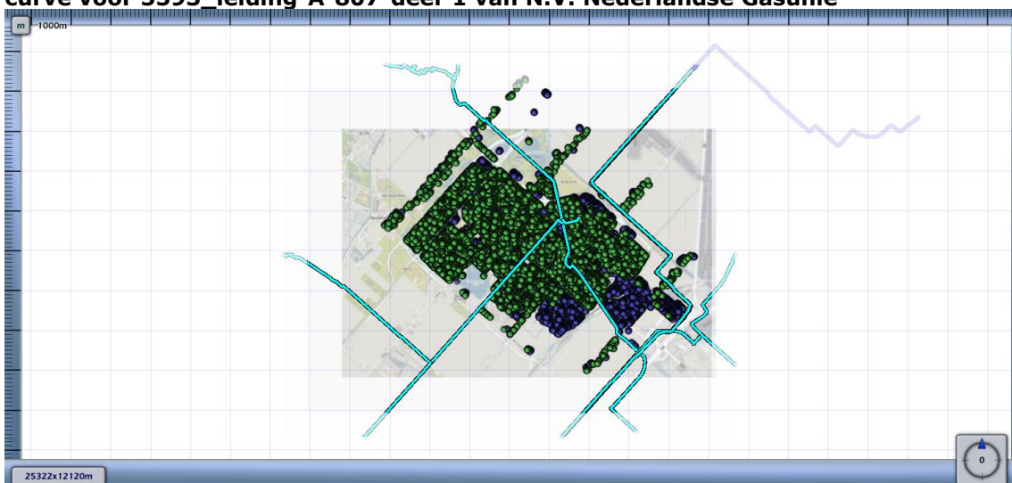
Figuur 4.4 Kilometer leiding behorende bij de maximale overschrijding van de FN-curve voor 5593_leiding-A-807-deel-1 van N.V. Nederlandse Gasunie
