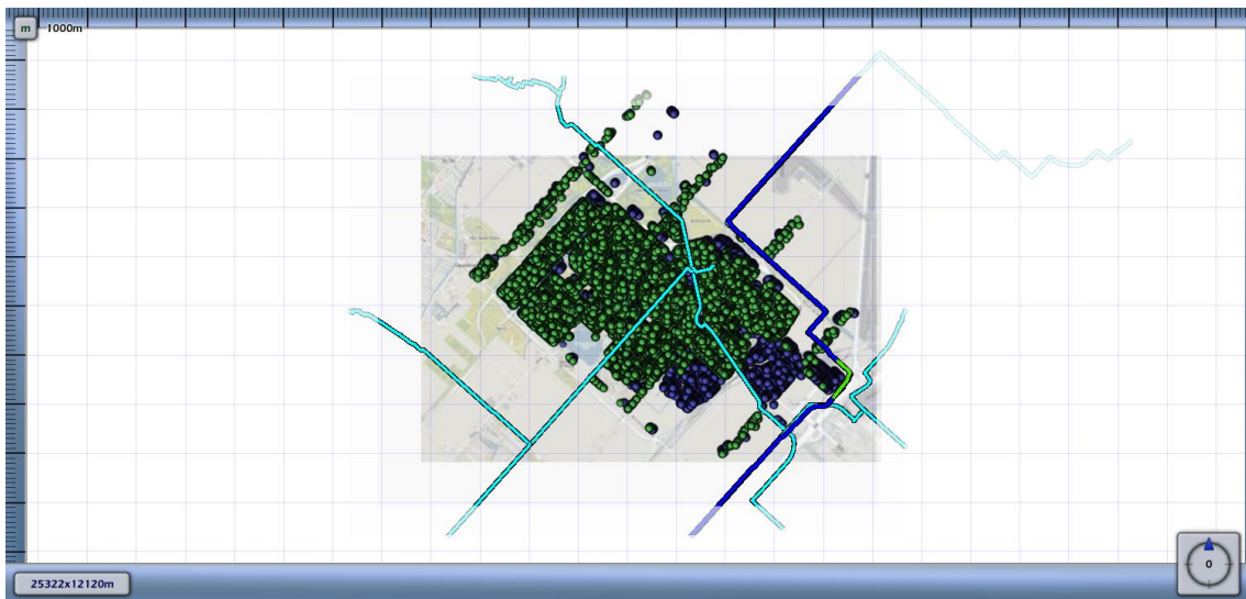
4.4 Figuur 4.4 Groepsrisico screening voor 5593_leiding-A-807-deel-1 van N.V. Nederlandse Gasunie
