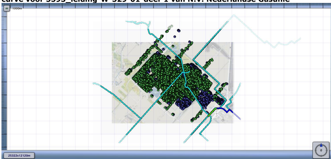
Figuur 4.6 Kilometer leiding behorende bij de maximale overschrijding van de FN-curve voor 5593_leiding-W-529-01-deel-1 van N.V. Nederlandse Gasunie
