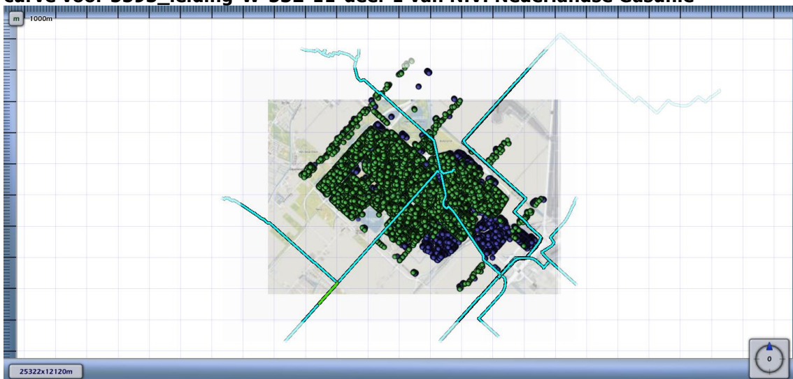
Figuur 4.13 Kilometer leiding behorende bij de maximale overschrijding van de FN-curve voor 5593_leiding-W-532-11-deel-1 van N.V. Nederlandse Gasunie
