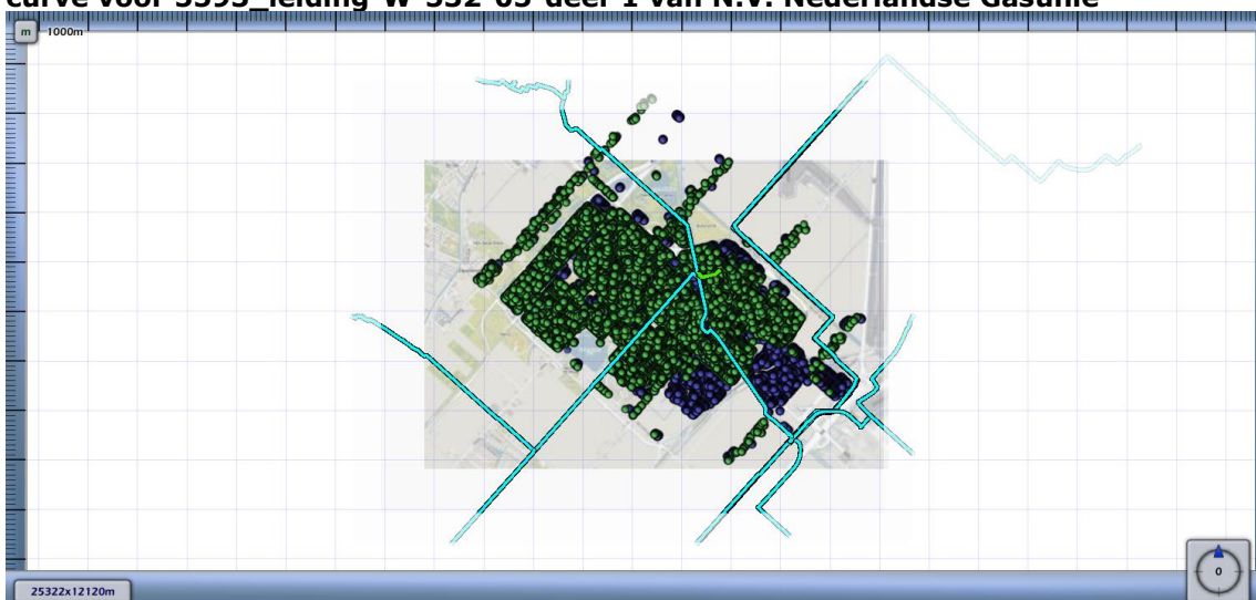
Figuur 4.11 Kilometer leiding behorende bij de maximale overschrijding van de FN-curve voor 5593_leiding-W-532-05-deel-1 van N.V. Nederlandse Gasunie
