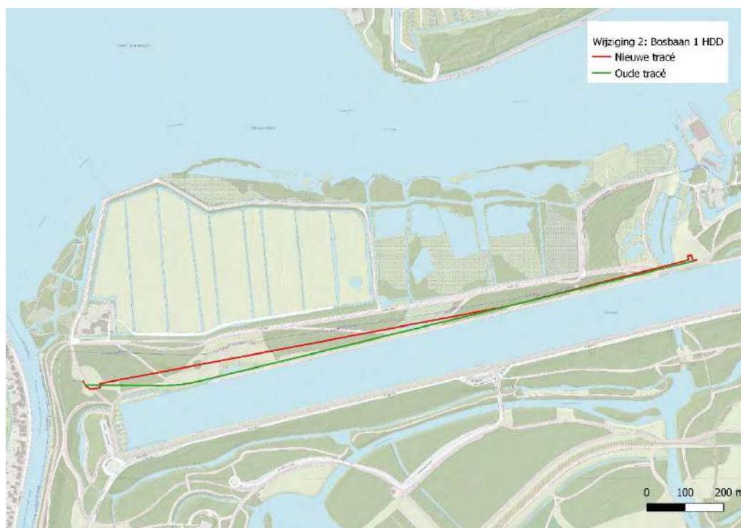
Figuur 3. Wijziging 2: de nieuwe gasleiding Bosbaan Amstelveen wordt middels één lange HDD (boring) aangelegd.
