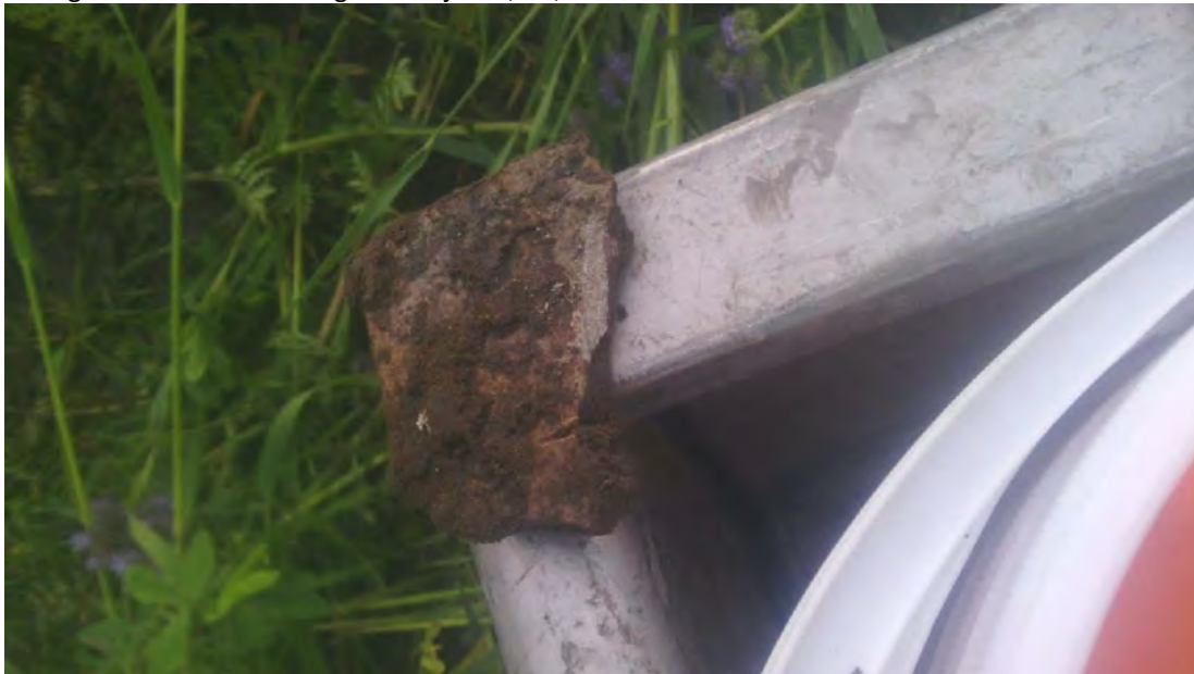
Proefgat 0704: aangetroffen stukje asbestverdacht materiaal
