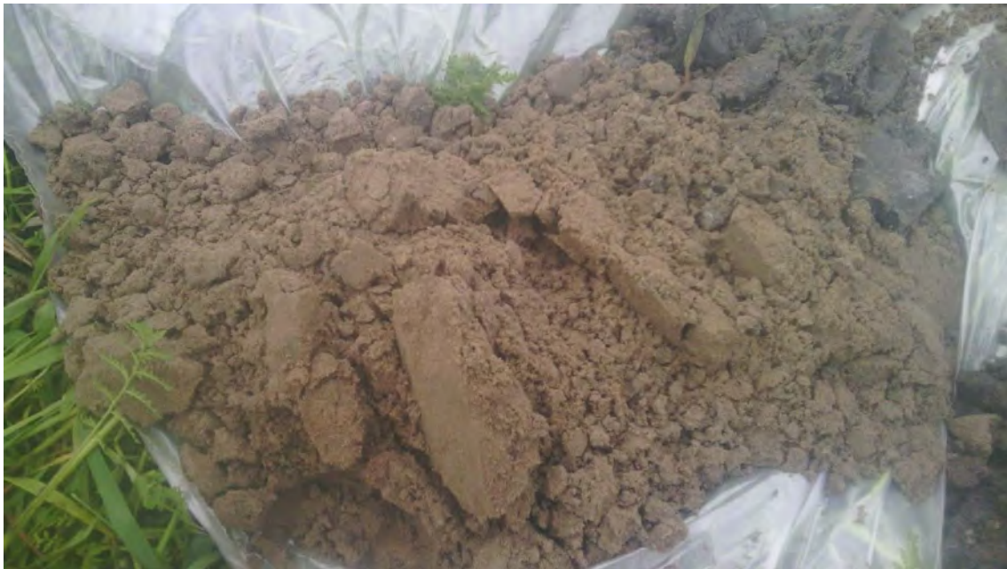
Proefgat 0607: uitkomende grond traject 0,5-1,5 m-mv.
