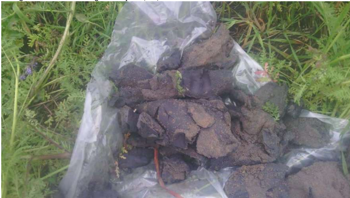
Proefgat 0607: uitkomende grond traject 1,5-2,0 m-mv.
