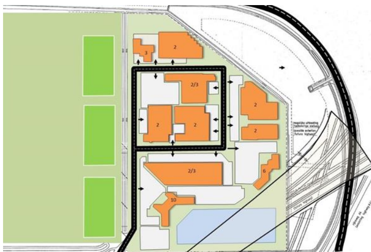
Figuur 8. Schematische opzet bedrijvenpark met ontsluiting, bouwlagen en parkeerterreinen (aan de zuidzijde het geprojecteerde tracé van de verlegde A9)
