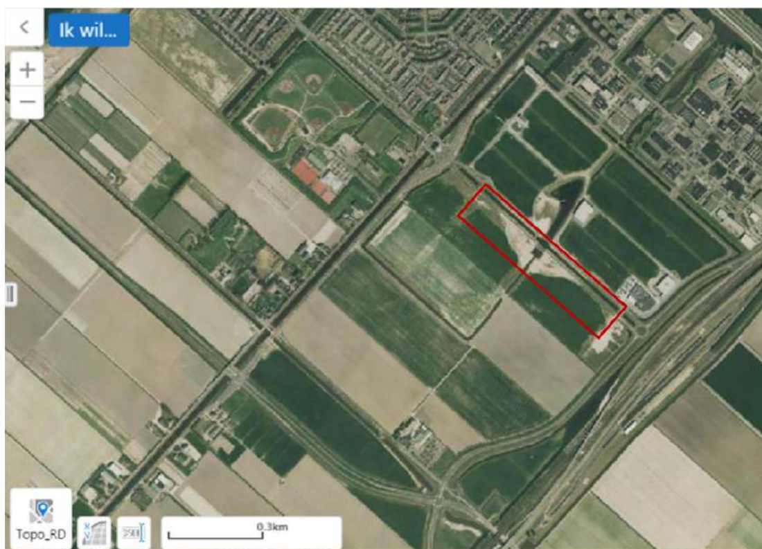
Figuur 3.7 Luchtfoto uit 2007 met locatie nieuw aangelegd water en gedempte watergang gearceerd in rood. (Bron luchtfoto: gemeente Haarlemmermeer).
