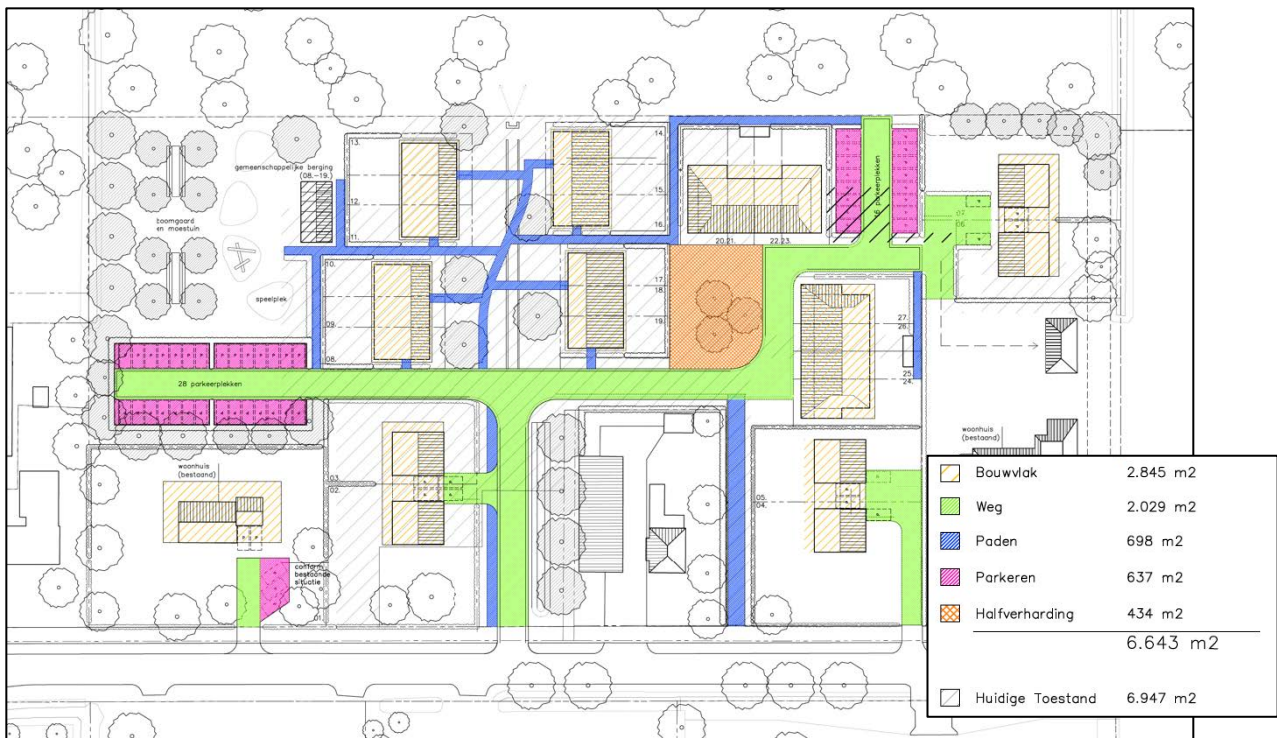
Afbeelding 5.6 Overzichtstekening verharding toekomstige situatie (Bron: B+O Stedenbouw B.V.)
