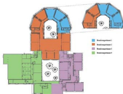
afb.11 Brandcompartimentering (bron: Korth Tielens architecten, terreininrichting indicatief)
