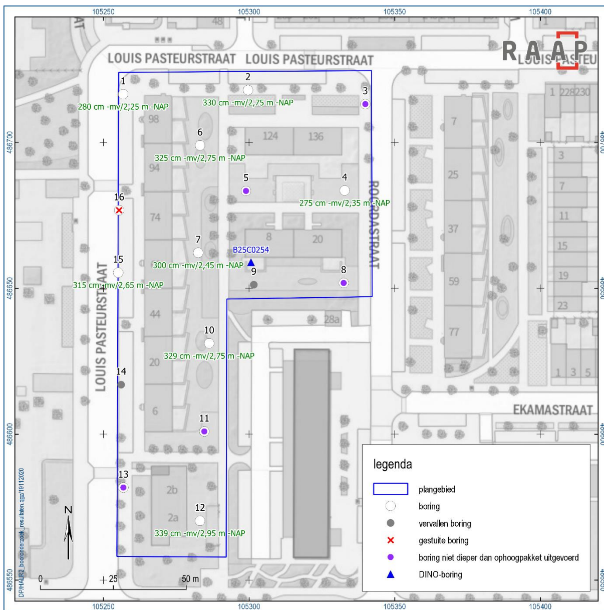
Figuur 2. Resultaten verkennend booronderzoek. De diepteligging van de top waarop ongeroerde natuurlijke afzettingen zijn aangeboord is met groene labels weergegeven.
