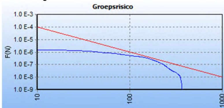
Figuur 7: fN-curve hogedruk aardgasleiding W-532-01 toekomstige situatie
