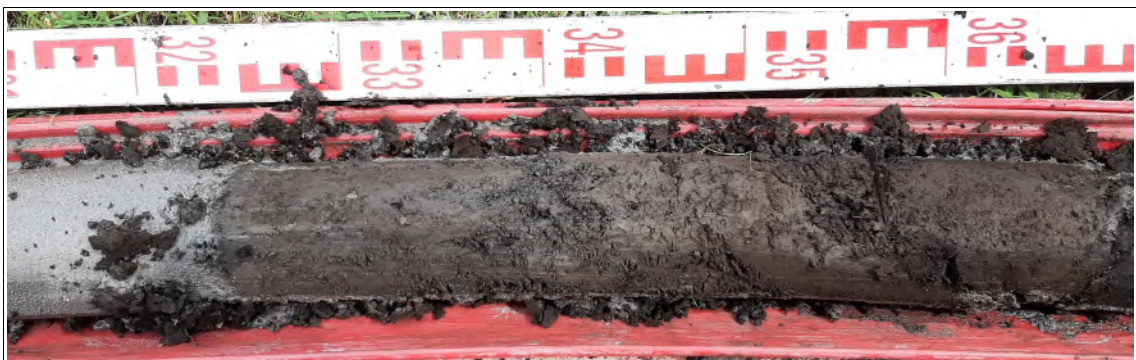
Figuur 18: Haarlem, Amerikaweg 4 (Belcanto/ROOTZ): monster boring 15 van 313 tot 370 centimeter diepte. Van 325 tot 355 centimeter ligt een dikke oude bouwvoor van kleiig veen. Rechts ervan het onderliggende ongeroerde veen en links ervan het grijze zand dat is opgebracht bij het bouwrijp maken van het gebied in de jaren '60.
