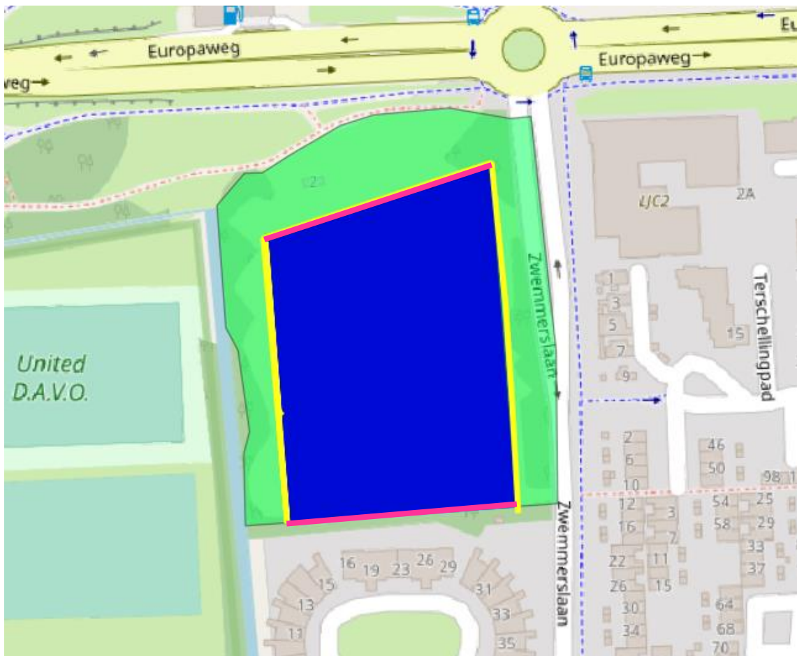
Figuur 12 – kelder is grondwaterneutraal bij toepassen maatregelen langs gevels welke geel zijn (voor alle oplosrichtingen). Bij paarse gevels zijn maatregelen oplossing 4 alleen noodzakelijk.
