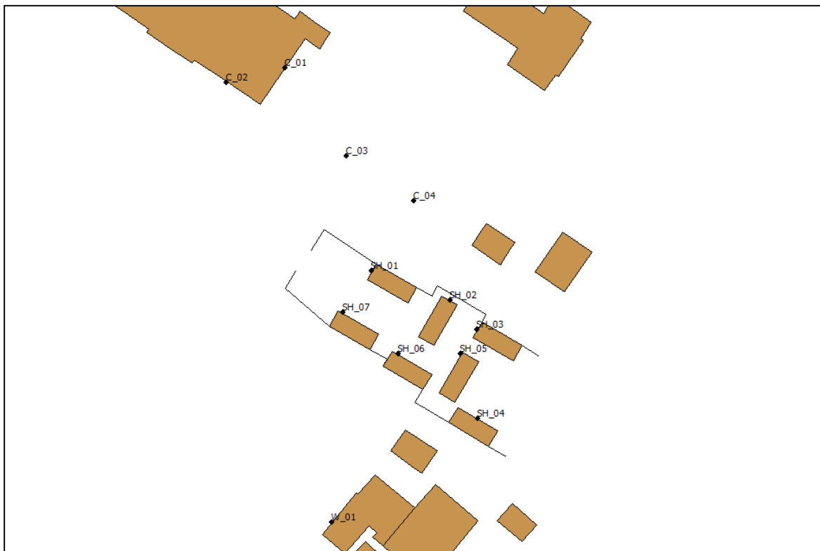
Figuur 3.1: Uitsnede rekenmodel met ligging rekenpunten
