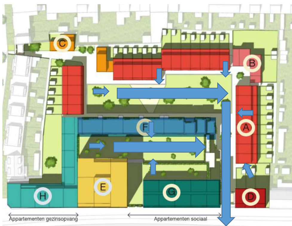
Figuur 5.1: Schematisering hemelwaterafvoer
