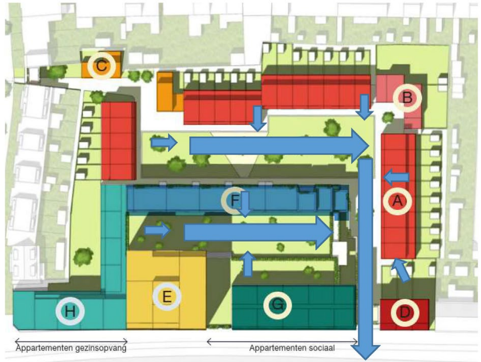
Schematisering van wateropvang- en afvoersysteem
