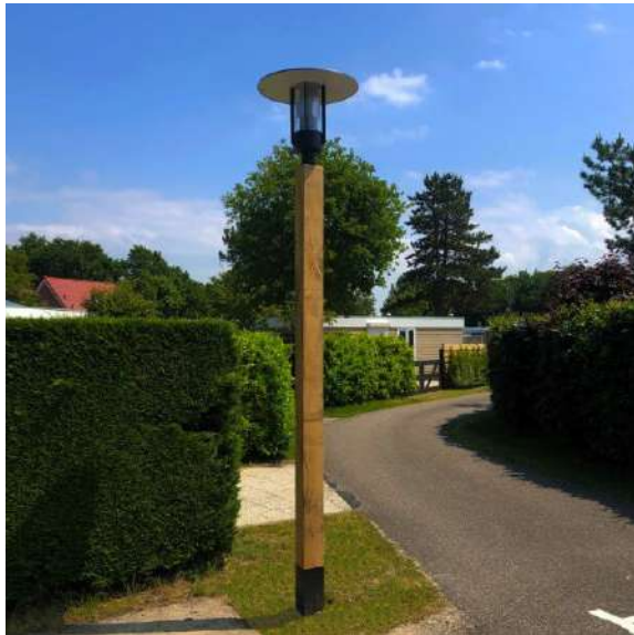
Paaltop Mast: Pila (leverancier bv. Van Hees infra); hoogte 4m. Houtsoort Accoya. puntstuk 76mm. Armatuur: Philips Osiris LED, afwerking aluminium, kleur Futura Gris 900 Sable
