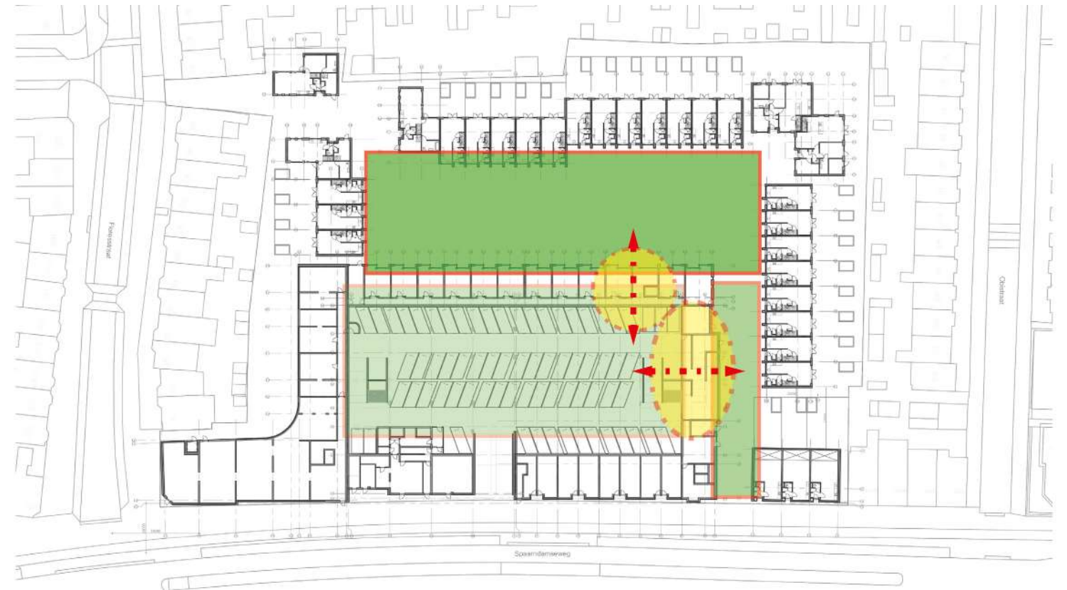
De belangrijkste verbindingen tussen begane grond en tuin op het dak van de garage
