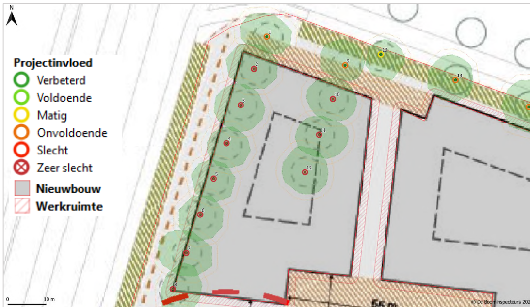
Afbeelding 15. Noordwestzijde van het gebied (kruising Pr. Beatrixplein en Pr. Bernhardlaan). Onder het gebouw komt een parkeerkelder. De bomen binnen de nieuwbouw ondervinden een fatale invloed. De bomen bij de zoekzone van de wadi zijn beoordeeld als onvoldoende, omdat graafschade zal ontstaan binnen de kroonprojectie. Het is mogelijk om de wadi aan te leggen buiten de stabiliteitskluit van de bomen.
