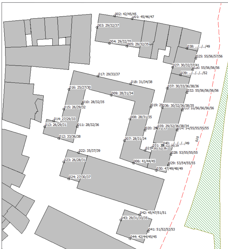
Afbeelding 4-1 Geluidsbelasting in dB, door verkeer op de Gedempte Oostersingelgracht inclusief correctie (hoogte 1,5m/4,5m/7,5m/10,5m/13,5m)
