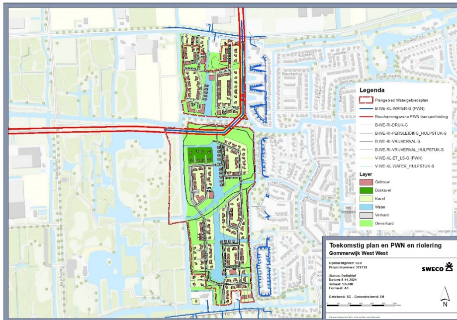
Figuur 3.6: Indicatieve ligging transportleidingen drinkwater beton 1400 door de proefverkaveling van de ontwikkeling (KLIC-melding).
