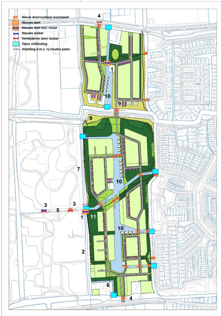
Figuur 3.6: Principe doorvaarbaarheid kunstwerken en aan te brengen en te verwijderen kunstwerken, zie ook bijlage 4.
