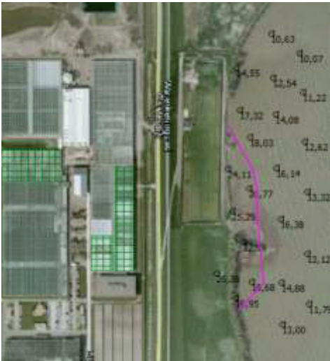
Figuur 7.1.1: 0,1 lux contour bij onbewolkt weer in 1998
