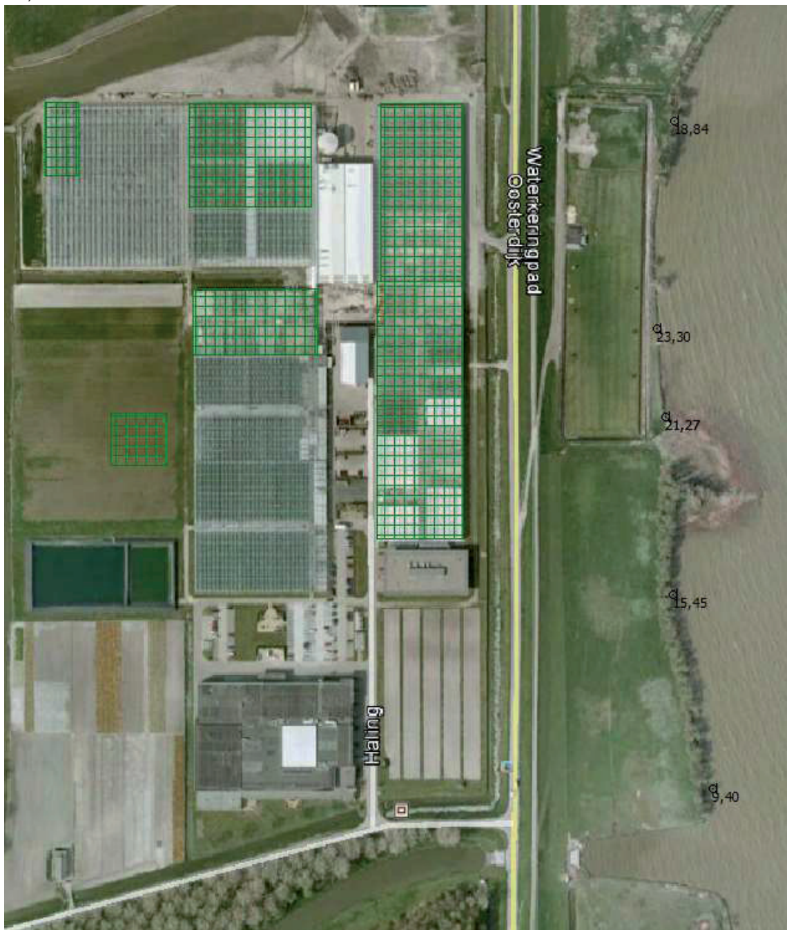
Figuur 6.2: Luminantie bij onbewolkt weer als gevolg van assimilatielampen in 2014
