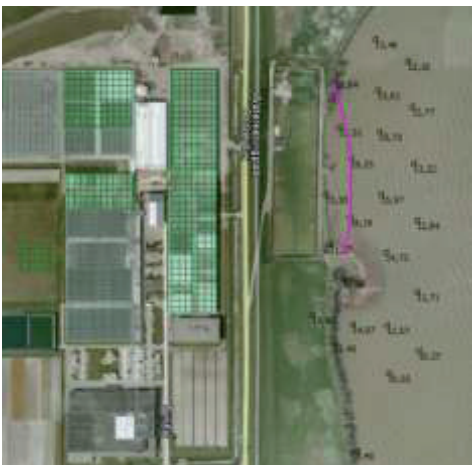
Figuur 7.1.3: 0,1 lux contour bij onbewolkt weer in 2014
