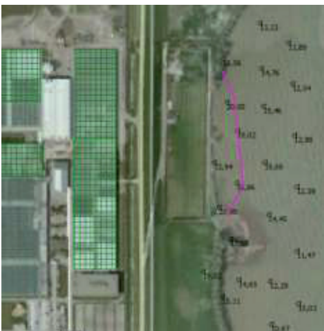
Figuur 7.1.2: 0,1 lux contour bij onbewolkt weer in 2013
