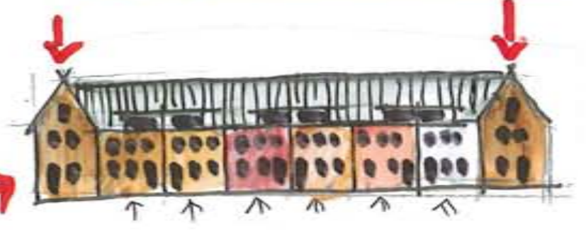
WOON BLOK : HORIZONTALE GELEDING INDIVIDUALITEIT D.M.V. VOEGWERK EN/OF VARIATIE IN METSELWERK - KLEUR
