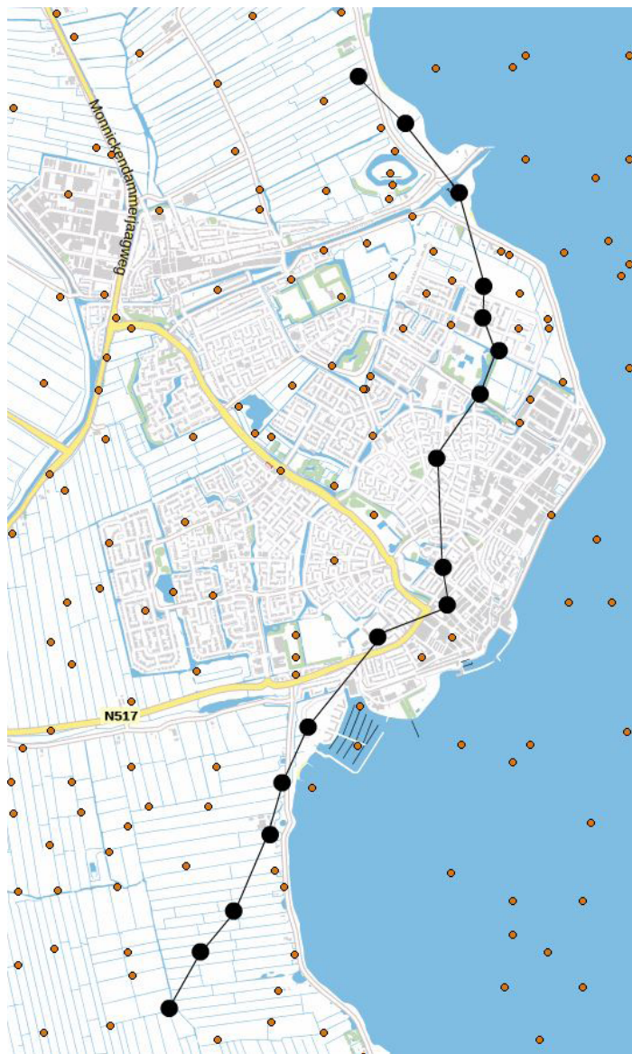
Afbeelding 6. Overzicht van de boringen (GeoTOP v1.3) die gebruikt zijn voor het maken van het zuid-noord geïoriënteerde ondergrond-model (afbeelding 5).
