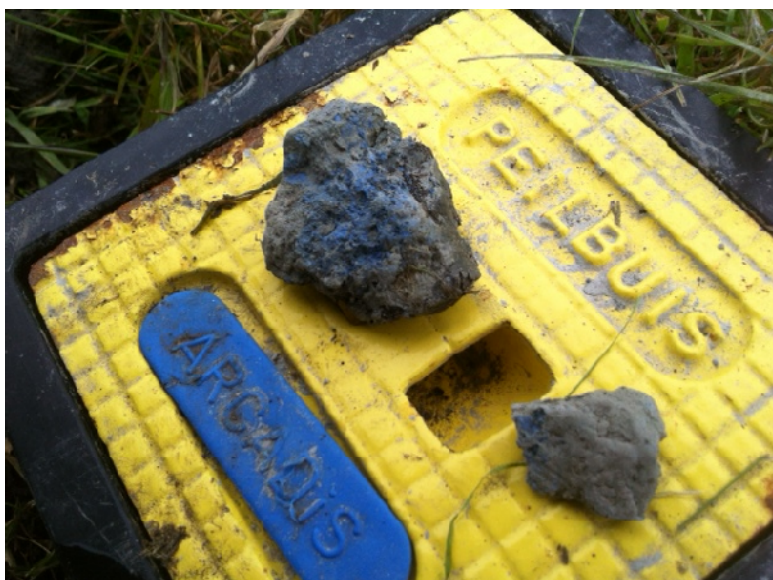
Foto 1 Blauw verkleurde grond bij peilbuis 12. De verkleuring wordt toegeschreven aan het mineraal vivianiet.
