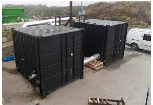
figuur 11: brikettenpers (links), carbonisatie-unit/containers (rechts)
