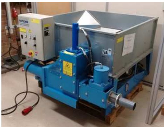
figuur 11: brikettenpers (links), carbonisatie-unit/containers (rechts)
