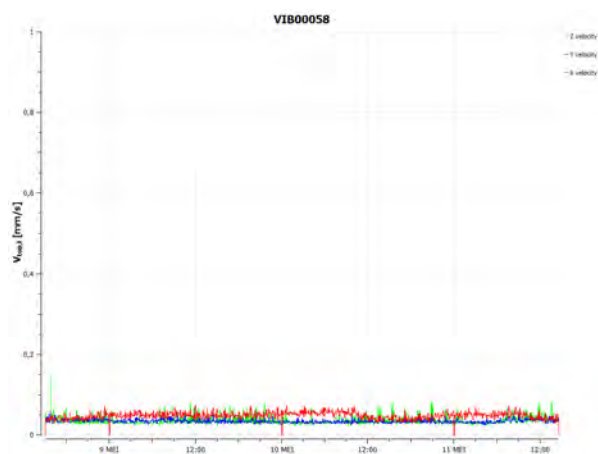
Figuur 3-9: C2.1, VIB058, op diepte (MV-20,0m) snelheid vs. tijd Meetperiode: 8 t/m 11 mei 2015
