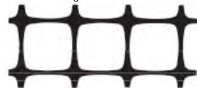
Te gebruiken in o.a. wegen Figuur 4.16 Voorbeeld geogrids
