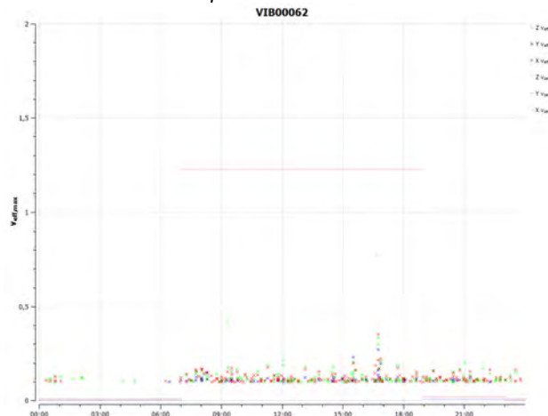
Figuur 3-19: T1.1, VIB062, op maaiveld V_{eff,max} vs. periode van de dag Meetperiode: 8 t/m 11 mei 2015
