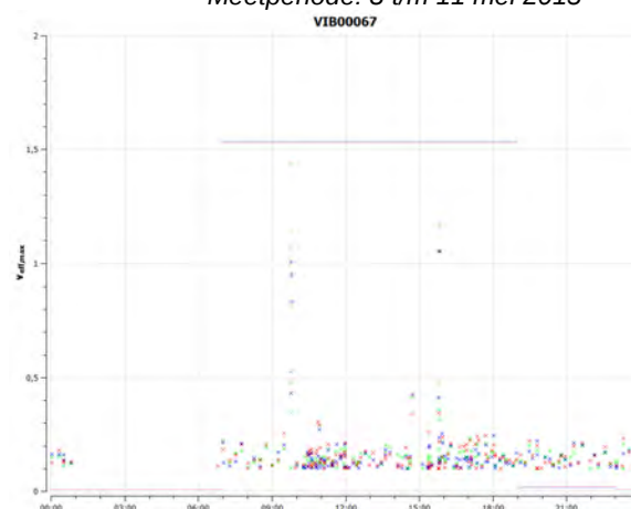
Figuur 3-22: T2.1, VIB067, op maaiveld V_{eff,max} vs. periode van de dag Meetperiode: 8 t/m 11 mei 2015
