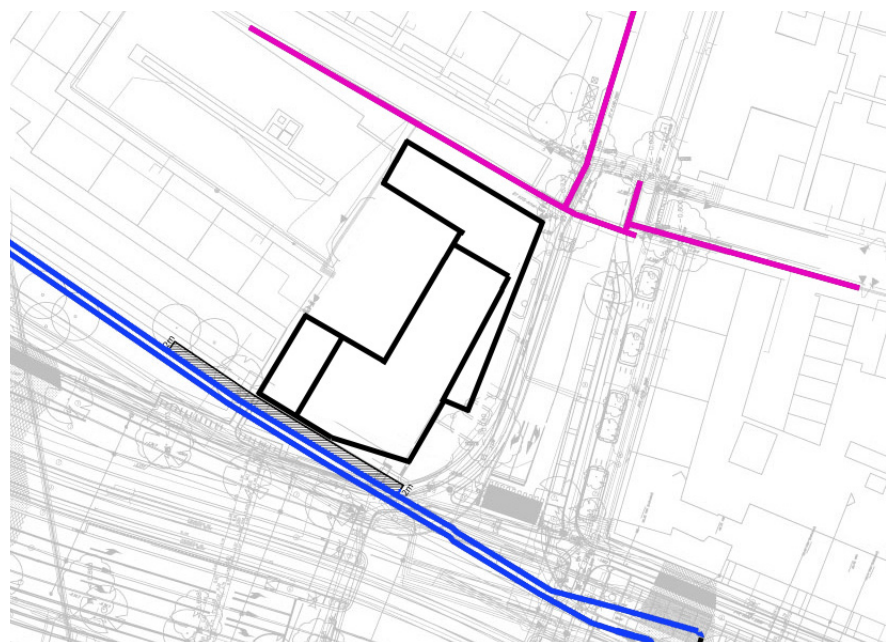
Voldoende afstand (min 2m) houden tot de waterleiding aan de zuidzijde.
